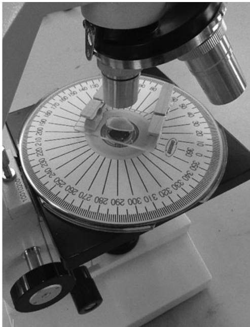
図3 作製した簡易偏光顕微鏡
